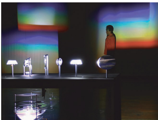
Das Experiment erzeugt simultan komplementäre Spektren. Die Lichtquelle befindet sich unter dem Tisch und besteht aus einer Xenon-Hochdruck-Lampe, die sich im Brennpunkt eines großen Hohlspiegels befindet. Zentrales Bauteil ist eine verspiegelte Spaltblende, an der das Spaltspektrum Newtons (rechts) und das Stegspektrum Goethes (links) gleichzeitig entstehen. Damit wird gezeigt, dass sich diese beiden Spektren in ihrer Entstehung bedingen. Foto: Susanne Böttge
